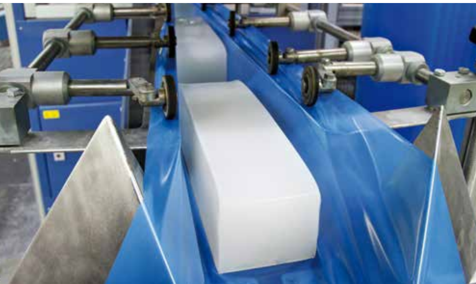
Standardlieferform Festsilikonkautschuk (Block/Riegel)
