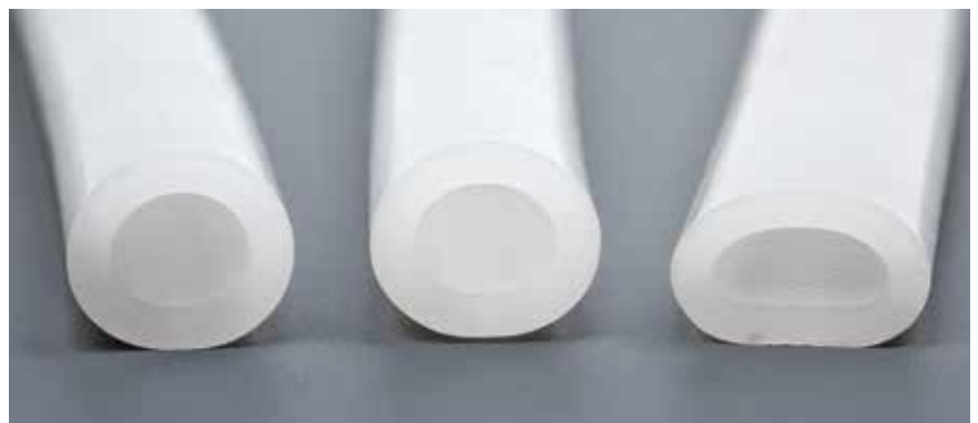
Schwankungen in der Extrudatgeometrie
