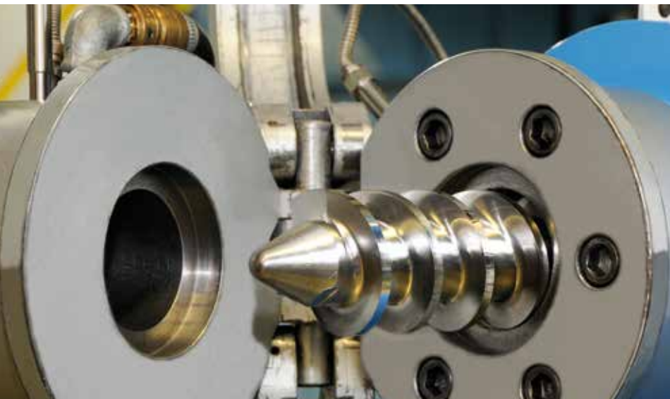
Geöffneter Extruder mit Förderschnecke
