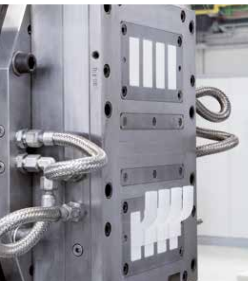
Spritzgussanlage für 2K-Verbundmaterialien
