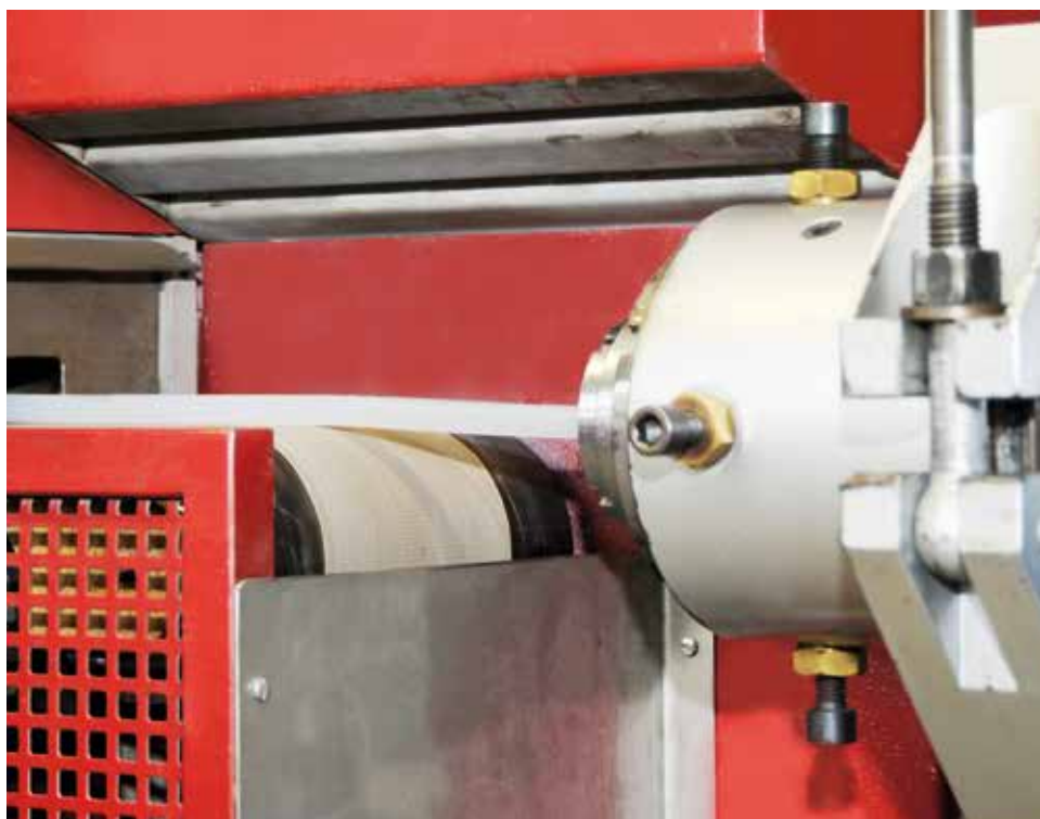
Extrusion von ELASTOSIL® Festsiliconkautschuk zu Schläuchen
