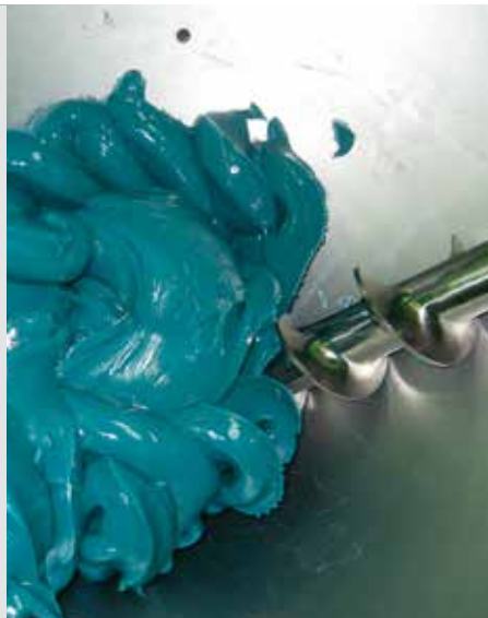
Innenansicht RotoFeeder®: Zuführtrichter mit Förderschnecke
