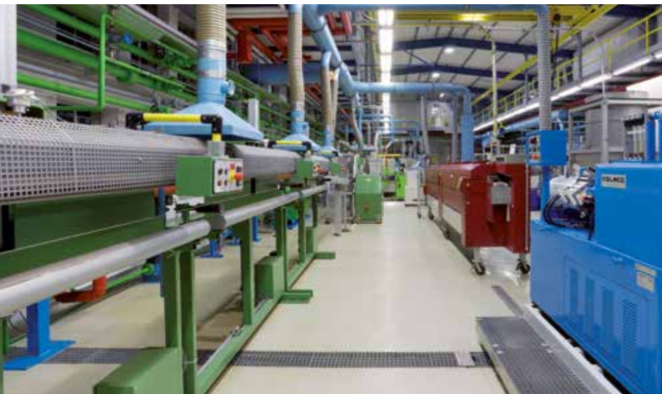
Kabelproduktion: Extrusion mit anschließender Vulkanisation im Infrarotkanal
