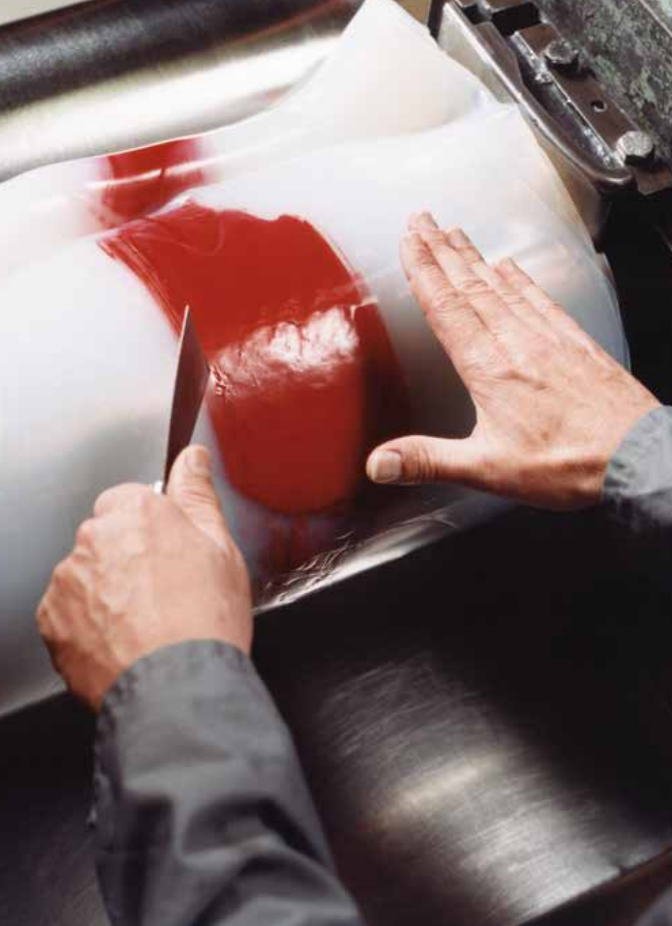
ELASTOSIL® Farbpasten lassen sich auf der Walze besonders leicht und schnell einarbeiten
